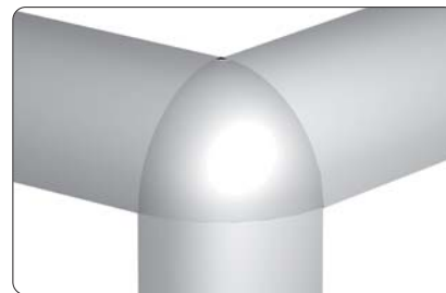
Vértice esférico: Para conexión de tres perfiles soft.
