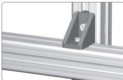
Montaje transversal al perfil. Para esta aplicación hay que eliminar la pestaña de posicionamiento en una de las dos caras.
