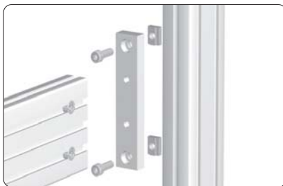
Fijación directa de perfiles 30×100
